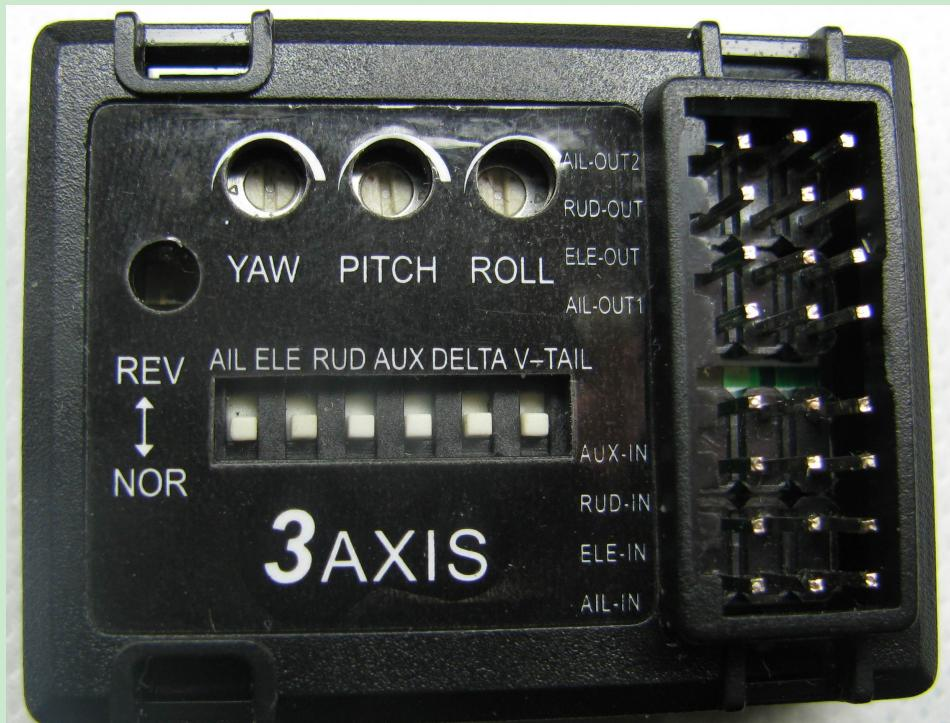
TL-3AXIS-A 固定翼专业 3 轴陀螺仪适用于固定翼模型飞机增加稳定性，使得新手能够快速体验到驾驭航模的乐趣。
